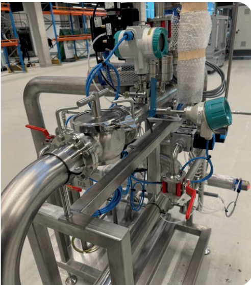
Estación para recoger y devolver el rascador de tubos en versión ATEX en una planta de producción de productos de limpieza.
