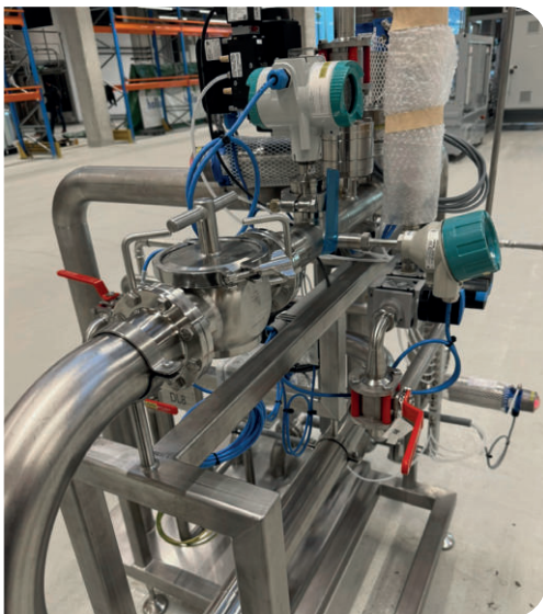
Trubkový zachycovač pro zachycení a vrácení ježka v provedení ATEX v zařízení na výrobu čisticích prostředků
